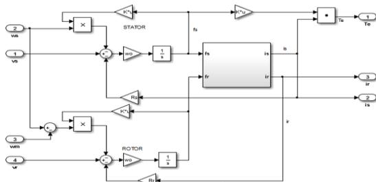
Fig. 6 DFIG Simulink model
